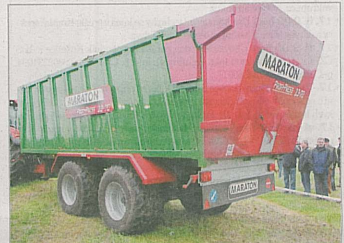
Zajímavou novinkou byl návěs Maraton Profi-Press 23-70 s hydraulicky výtlačným čelem a zadní říditelnou nápravou Foto Vladislav Fuka
