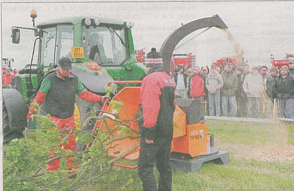
Belgický štěpkovač Vandaele TV 180 je schopen drtit materiál o průměru do 180 mm Foto Vladislav Fuka
