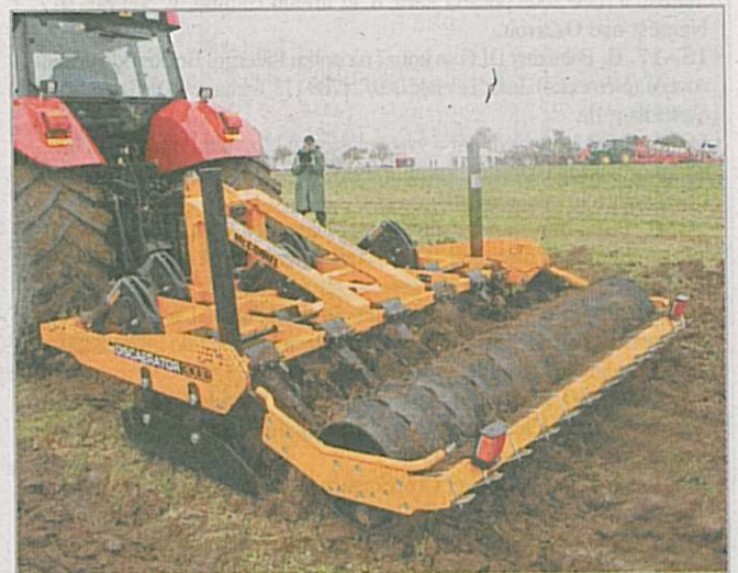
Značku McConnell nosí také řada strojů na zpracování půdy. V Bečvárech byl poprvé v akci předveden podrývač Discaerator 3000 o záběru 3 m Foto Jiří Hruška
