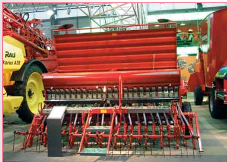
První secí stroj Accord s mechanickým výsevním ústrojím M-drill.
