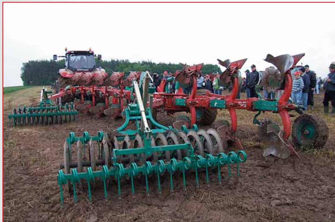
S pluhem PW si zemědělec může vybrat, zda využije plný záběr, nebo každý z pluhů samostatně.
