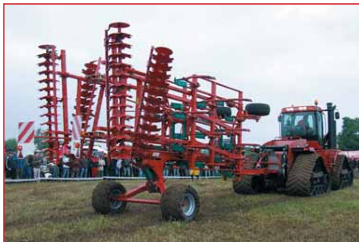
Radličkový podmítač CTC se přizpůsobuje různým půdním podmínkám.
