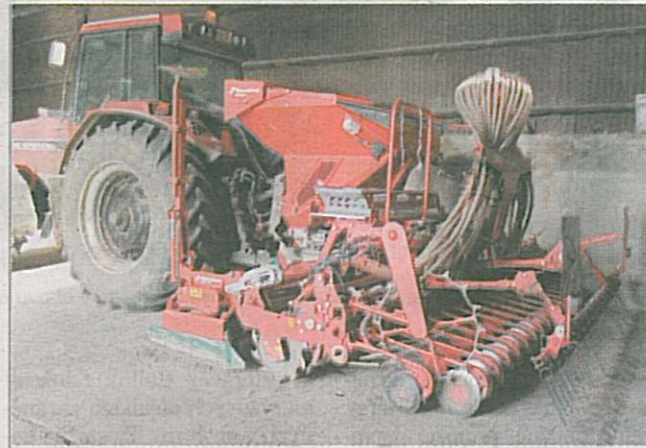
Secí stroj Kverneland I-Drill s rotačními bránami NG S401 Foto Martina Paulová
