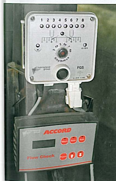
Díky čidlům na semenovodech může obsluha stroje přímo v kabině identifikovat problém
