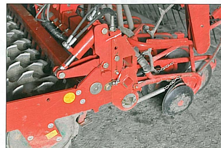
Tam, kde je potřeba půdu „dopřipravit“ je možné hydraulicky zvednout secí botky
