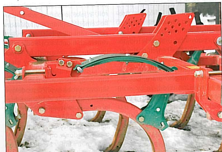
Jištění pracovních orgánů je řešeno listovými perami
