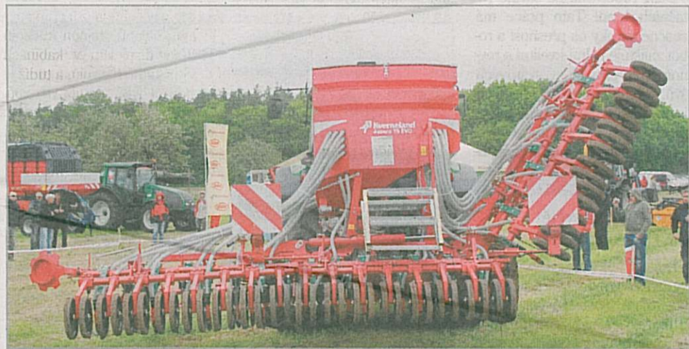
Radličkový secí stroj Kverneland Accord TS EVO o záběru 6 m s radličkami vzdálenými 12,5 nebo 15 cm Foto Vladislav Fuka
