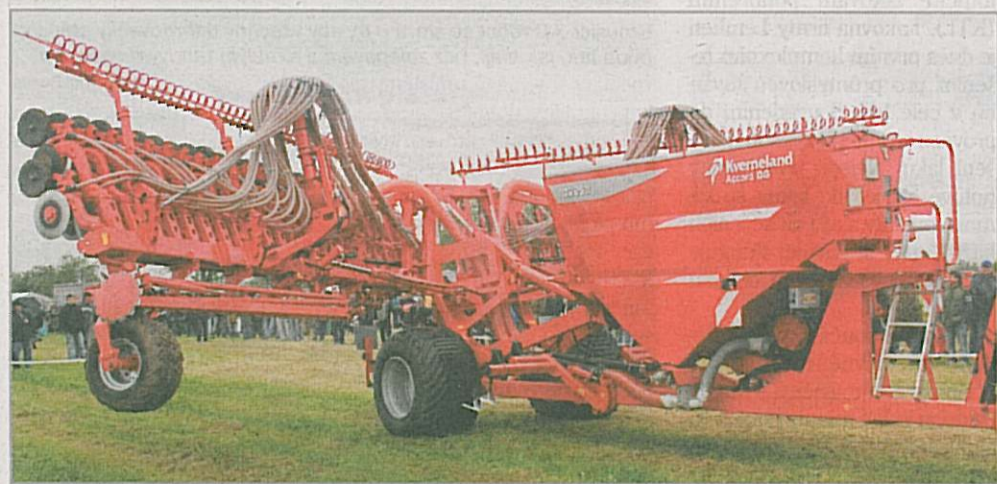
Kverneland Accord DG 12000 o záběru 12 m zaseje za směnu 80 až 100 ha Foto Vladislav Fuka
