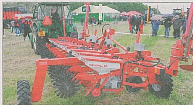
Secí stroj pro výsev obalovaného kalibrovaného osiva Kverneland Accord Monopill SE Foto Vladislav Fuka
