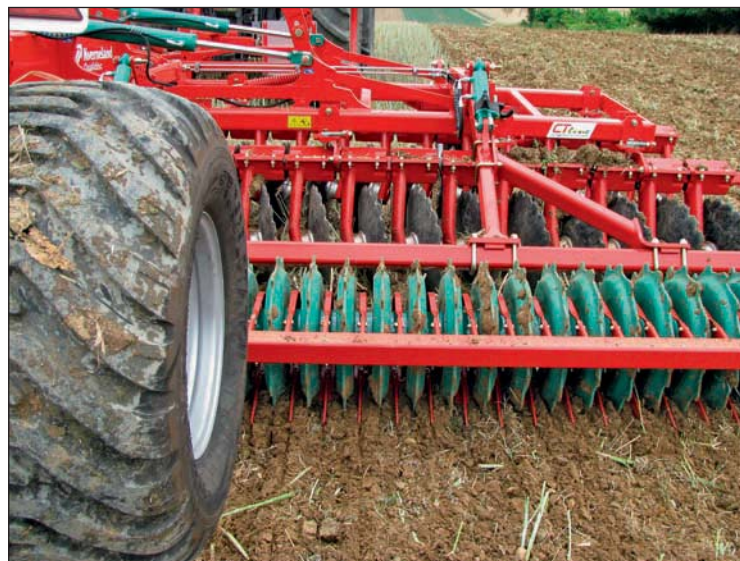
Jiří Trojan vybral na své těžké půdy diskový válec actipack. Jeho výhodou je, že se nelepi
