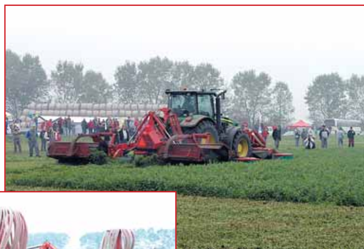
Třídílný žací stroj Taarup 5090 s pracovním záběrem 9,0 m předvádí co dovede.
