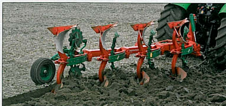
Varianta pluhu Kverneland 150 s jištěním pomocí listových pružin je vhodná do kamenitých půd
