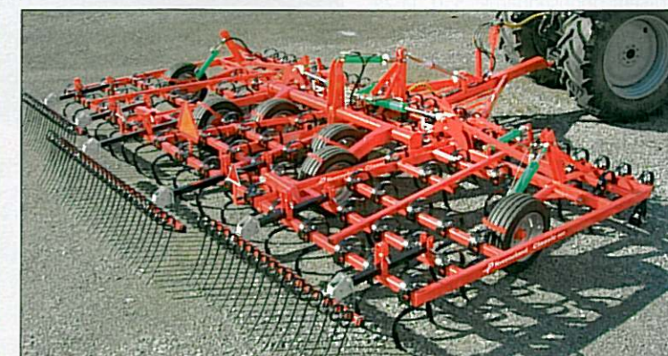
Provedení Classic je vyráběno s pracovním záběrem 5 nebo 6 metrů
