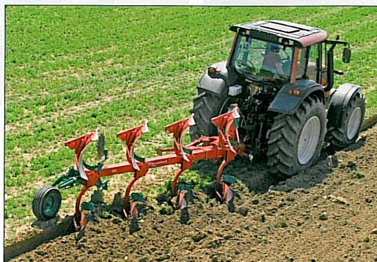
Pluh Kverneland 150 B ve čtyřradličném provedení
