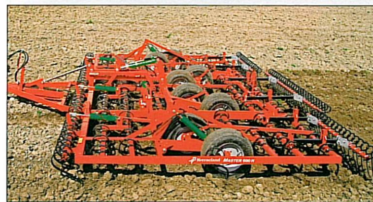
Šestimetrový Master 600 H používá sedm řad radliček uchycených k rámu přes pružné slupice
